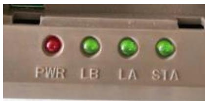
4个：电源灯（POW）、工作灯（STA）、链路1状态灯（LB）、链路2状态灯（LA）。
