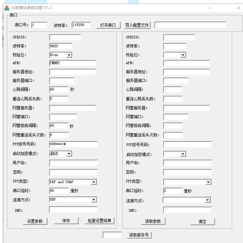
2、模块维护串口与 PC 串口连接好后通电，选择所用串口号后点击“打开串口”，当模块的状态灯（LED5）快速闪烁，代表可以设置或读取参数。
